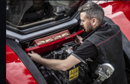
Temizlemek üzere kabin hava filtresini çıkarmak için kolay erişim.
